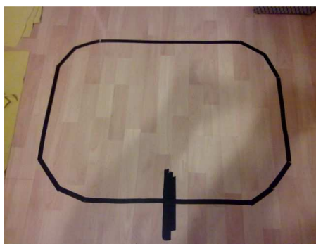
6. 5.ábra: A vonalkövető algoritmus tesztelésének első pályája
