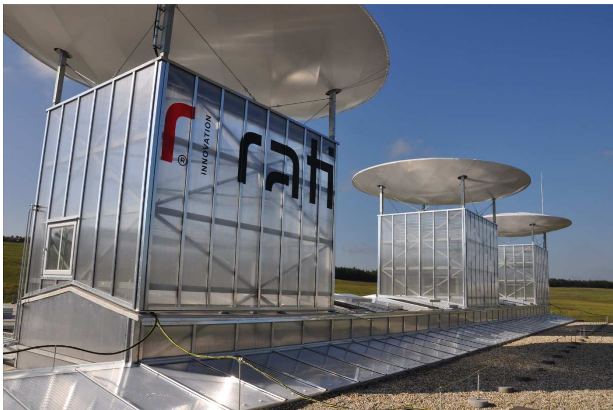
4.6. ábra: A kivitelezett kísérleti épület kiszellőztető széltornyai „Venturi” tányérszerkezetekkel
