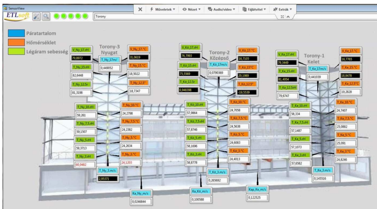
4.15. ábra: Az MMS (mobile monitoring system) komplex épület mérésadatgyűjtő rendszer. A termelőcsarnok természetes szellőzési rendszere a széltornyokban mért levegő hőmérséklet, páratartalom és áramlási sebességekkel
