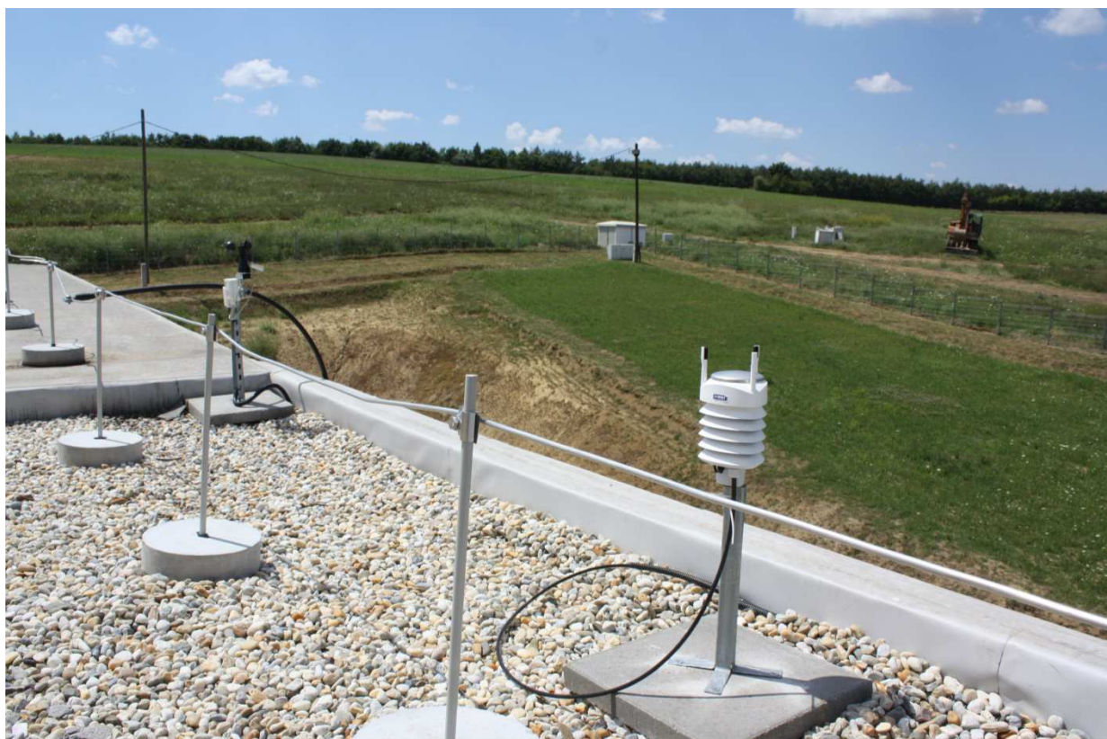
4.14. ábra: Vaisala WXT 520 komplex időjárás állomás mérőműszer a kísérleti épület nyugati peremén kb. az épület közép-vonalában elhelyezve
