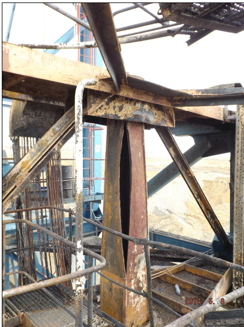
21. ábra A két gépet összekapcsoló királytengely doboz keresztmetszetű szelvénye a varrat mentén teljesen szétnyílt
