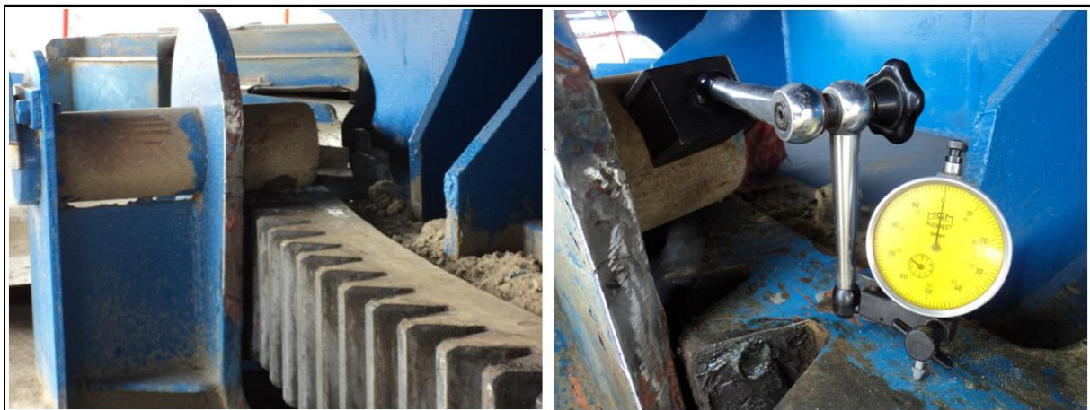
52. ábra Baloldali képen a golyóskoszorú feletti borulásgátló, míg a jobboldali képen a felszerelt indikátor óra látható
