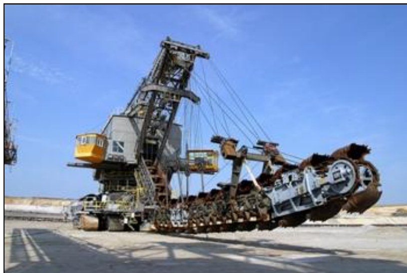
4. ábra Merítéklétrás bányagép képes a földről felkaparni a szenet [5]
