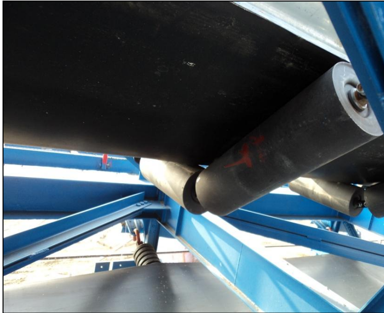
8. ábra Felül a sima felületű görgők, míg alul a háttérben takarva látszik a bordás kialakítású görgő
