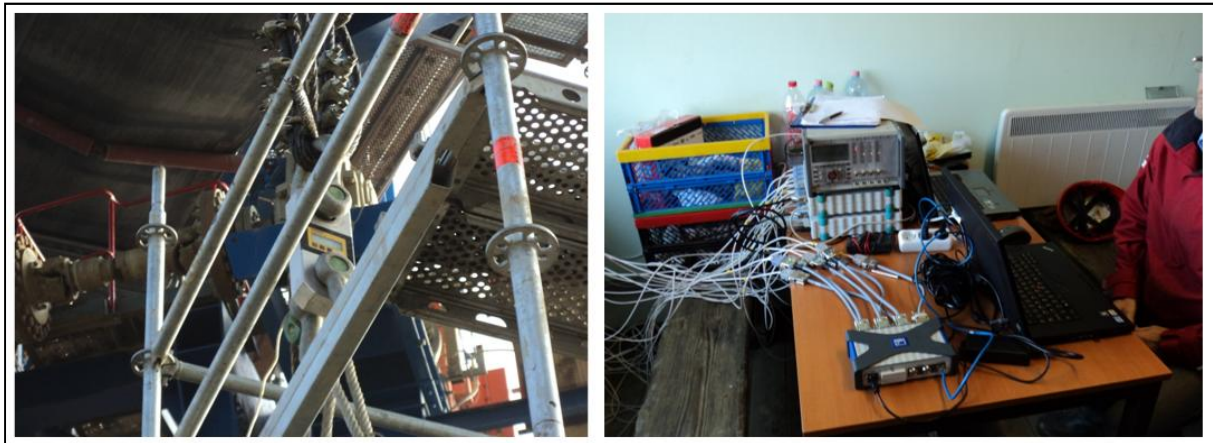
40. ábra Baloldali képen a kötélágon közbeiktatott digitális erőmérő, míg a jobboldali képen az adatrögzítő állomás látható
