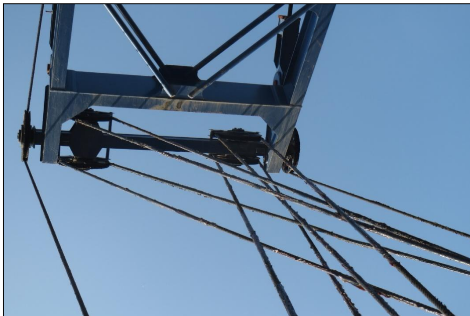
42. ábra Kötélkorongok sokszorozzák a kötélágakat az oszlopon
