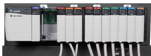
4. ábra: IO modul és IO kártyák összehasonlítása. A bal oldali ábrán egy Etherneten keresztül vezérelhető fejegység és a hozzá csatlakoztatott kártyák (6 db) láthatóak. Felépítése hasonlít a PLC-hez, de nem tartalmaz processzort. Jobb oldalon egy váz látható, benne tíz IO kártyával és egy processzorral. Jobbról a második és a harmadik hely üres a vázban, ez nem okoz semmilyen problémát.
