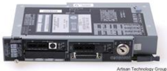
3. ábra: Egy vázba pattintható kártya. A képen egy Rockwell 1785-L40B Series C PLC-5/40 Processzor modul látható. Az előlapján látható kulcsos kapcsoló az üzemmód kiválasztását szolgálja. A legtöbb PLC három üzemmóddal rendelkezik: programozási üzemmódban a felprogramozott kód inaktív, de módosítható, futási üzemmódban a kód aktív, de írásvédett, távoli üzemmódban pedig a fejlesztőkörnyezeten lehet választani az előbbi két mód közül.
