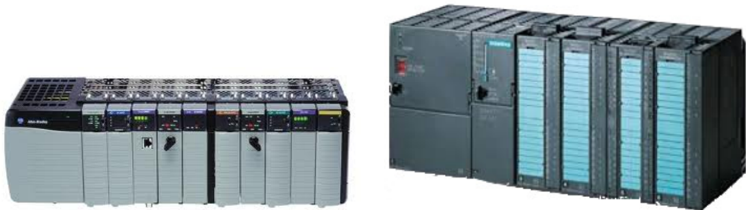
2. ábra: Példa a PLC-k moduláris felépítésére. A bal oldali ábrán egy Rockwell, jobb oldalon pedig egy Siemens PLC látható. Mindkettő alapja egy váz, melybe tetszőleges kártyákat lehet tenni.
