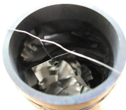
15. ábra: A nikkelfólia és a titánforgács a szénüveg tégelyben
