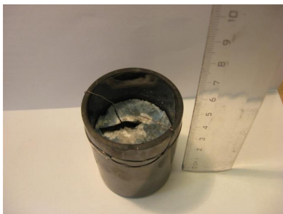
16. ábra: A kemencéből kivett szénüvegtégely és a tégelyből eltávolított só tömb
