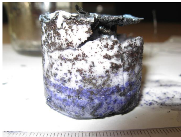
16. ábra: A kemencéből kivett szénüvegtégely és a tégelyből eltávolított só tömb
