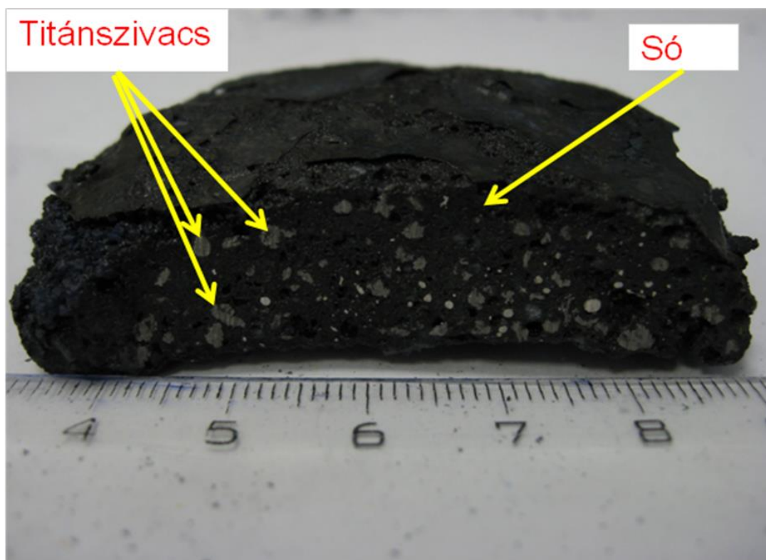
11. ábra: A só tömb keresztmetszetének felvétele
