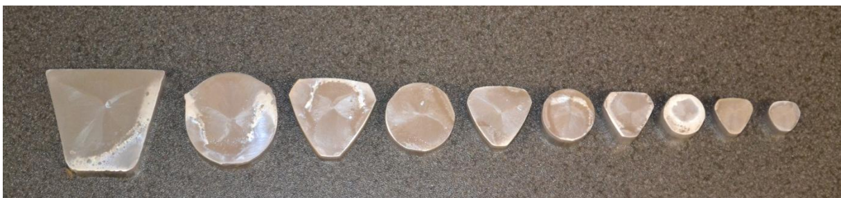
7. ábra Szemcseszerkezeti vizsgálatokra előkészített keresztmetszeti mintadarabok. Az egyes lépésekből kivett mintákat 1-10-ig számoztuk.
