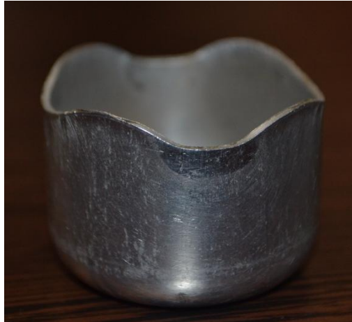
1. ábra Az alakítási textúra okozta fülesedés mélyhúzott alumínium félkész terméken
