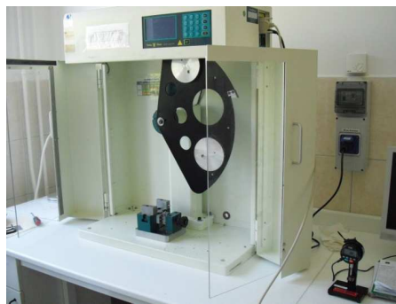
13. ábra - Tinius Olsen Impact 503 típusú ütőmű Forrás: A szerző saját felvétele; Készítve: 2013.07.29.
