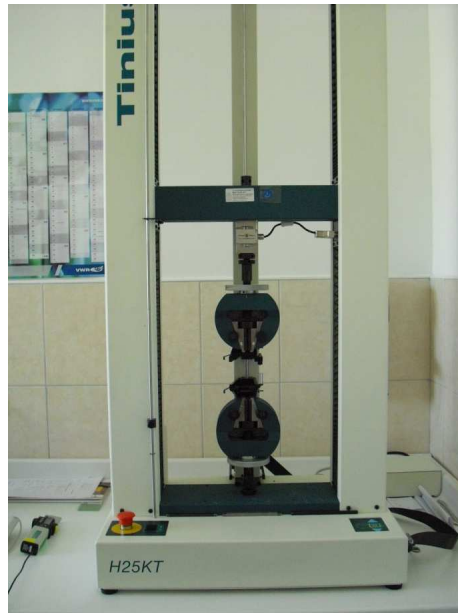
12. ábra - Tinius Olsen H25KT típusú szakítógép Forrás: A szerző saját felvétele; Készítve: 2013.07.29.
