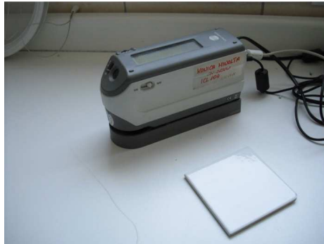
16. ábra - Konica Minolta CM 2600d típusú színmérő készülék
