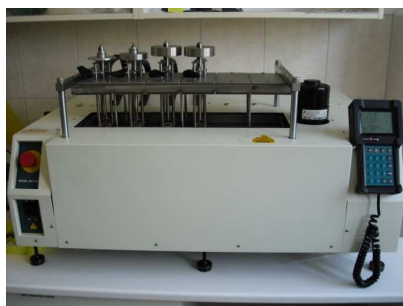
11. ábra - Tinius Olsen Model 603 HDTM típusú Vicat-féle lágyuláspont és HDT mérő készülék
