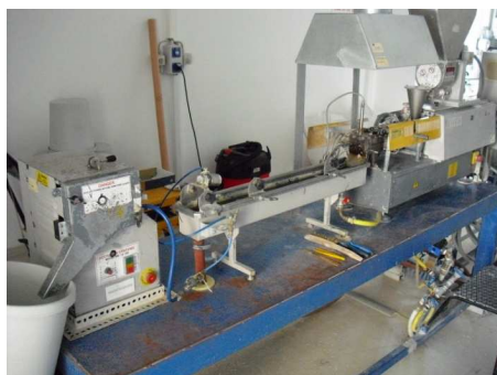
7. ábra - APV Baker típusú kétcsigás extrúder és az ACCRAPACK System BM-15 típusú vágógép
