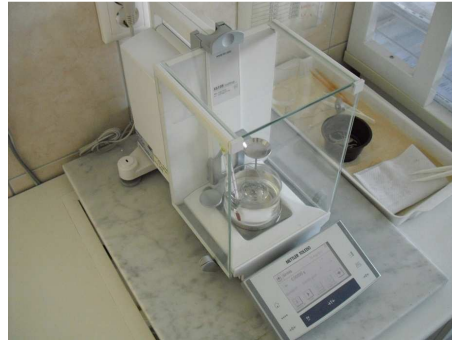
9. ábra - Mettler Toledo XS105 típusú sűrűség mérő készülék
