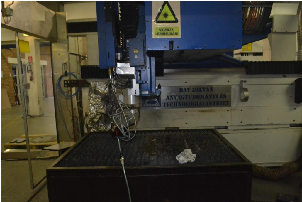
10. ábra: Az 5 kW teljesítményű gázlézer a BAY-ATI intézetben
