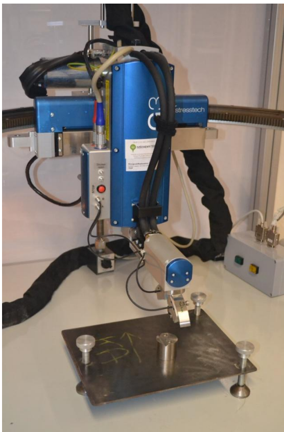
13. ábra: Stresstech XStress 3000 G3R típusú központ nélküli röntgendiffraktométer
