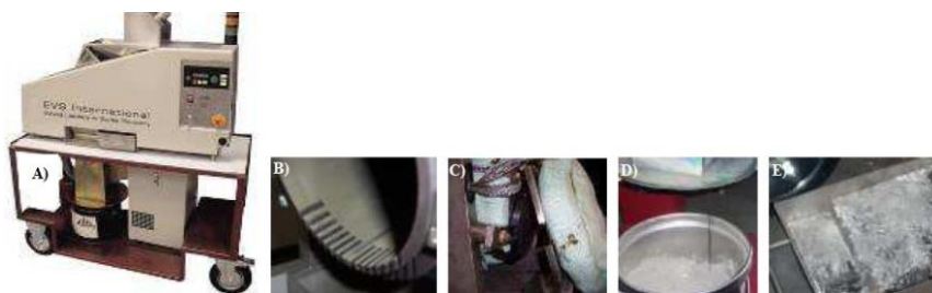
2. ábra Az EVS felzékfeldolgozó berendezés és annak főbb részei.
