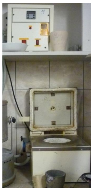
23. ábra Az oxidos felzék hevítése (a) és a felzékkezelő-kiolvasztó kemence képe (b).
