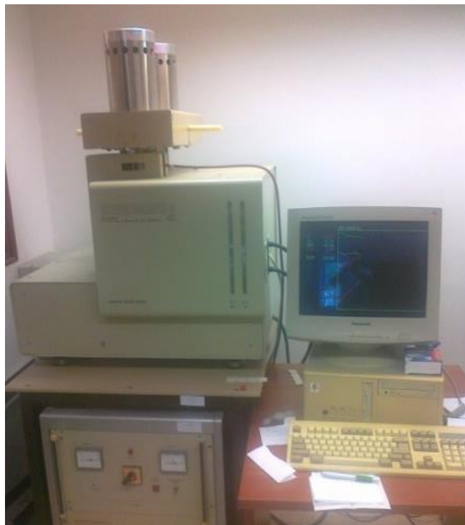
39. ábra Az ellenőrző vizsgálathoz használt derivatográf.
