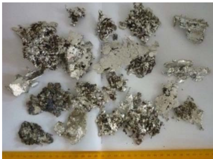
4. ábra Forrasztási/ónozási hulladék képe.
