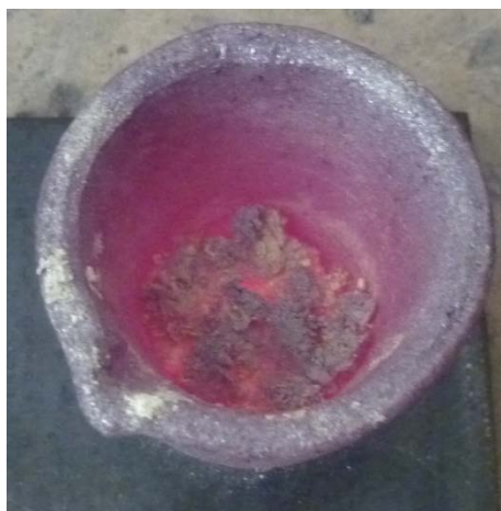
23. ábra Az oxidos felzék hevítése (a) és a felzékkezelő-kiolvasztó kemence képe (b).
