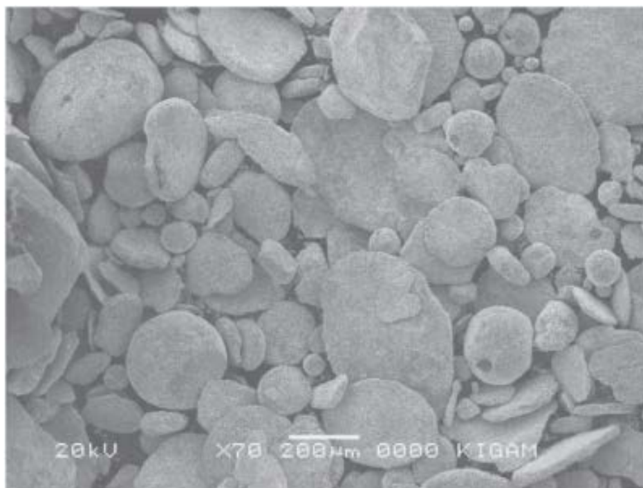
13. ábra 1023 K-en; 101,3 kPa nyomáson redukált ón szemcsékről készült SEM kép [11].
