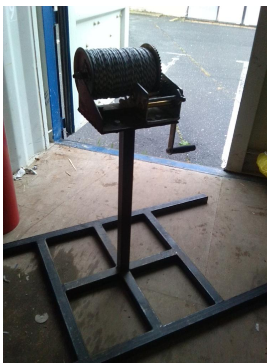
56. ábra A csörlő állványzattal és kötéllal
