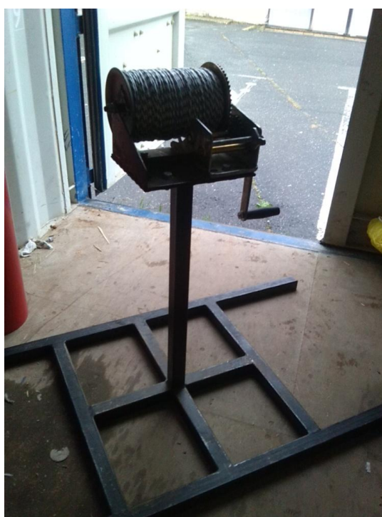
56. ábra A csörlő állványzattal és kötéllal
