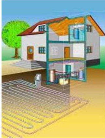
5. ábra: Talaj kollektoros rendszer elve [6]
