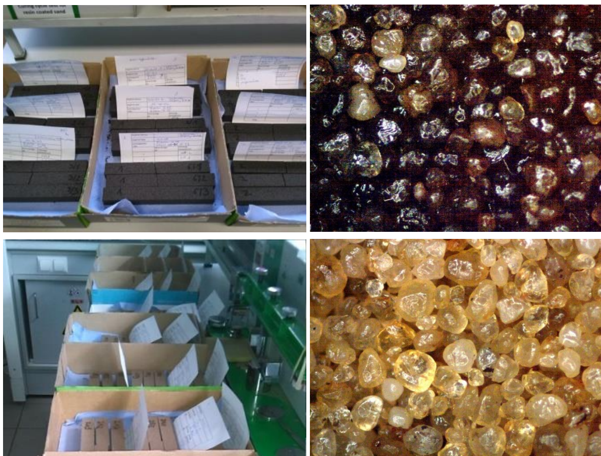
14. ábra Az elkészített próbatestek és sztereómikroszkópos felvételek a felületükről keverékregenerálás nélkül (felül) és keverékregenerálással (alul)
