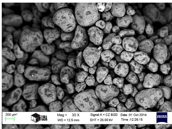
26. ábra Regenerált 10% szervetlen kötőanyagot tartalmazó próbatestek elektronmikroszkópos és sztereómikroszkópos felvétele
