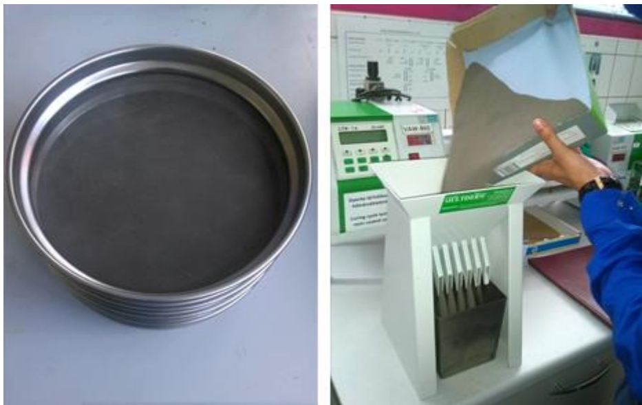
10. ábra Szervetlen homokkeverék szitálása és homogenizálása
