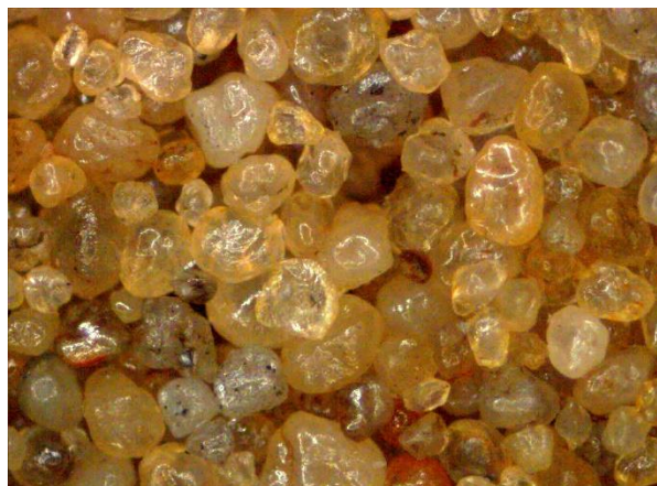
26. ábra Regenerált 10% szervetlen kötőanyagot tartalmazó próbatestek elektronmikroszkópos és sztereómikroszkópos felvétele
