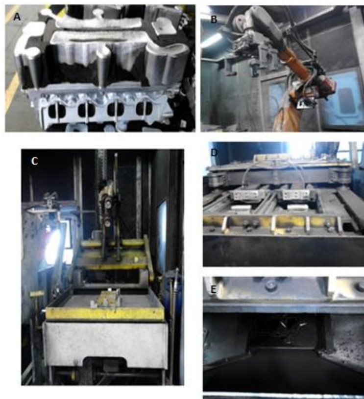
13. ábra Az ürítés folyamata A: „nyersöntvény” B: emelőrobot C: „kalapáló” állomás D: vibrációs berendezés E: surrantó
