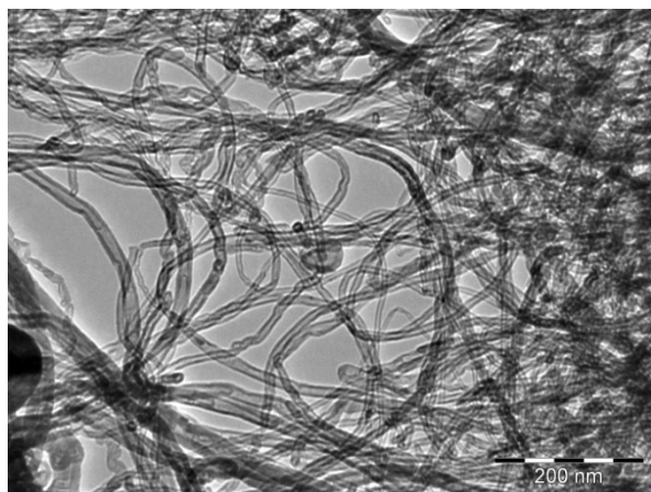
1. ábra Szén nanocsövek TEM felvétele
