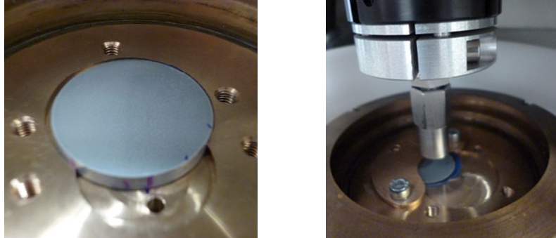
42. ábra. Az excentrikus mintabefogó (balra) és a benne rögzített minta (jobbra) a vizsgálat előtt
