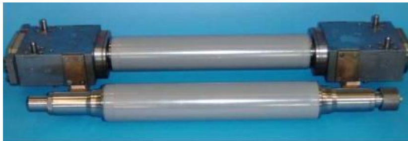
4. ábra. \text{Si}_3\text{N}_4 kerámiából készült hengerek alakító műveletekhez [11]
