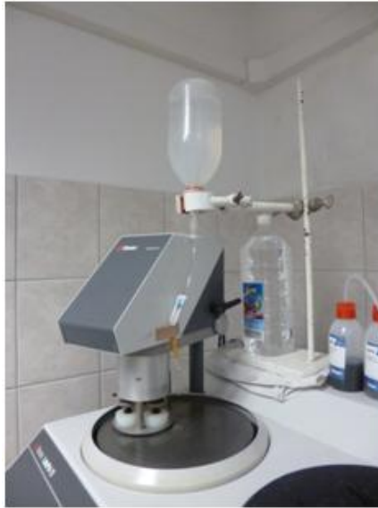
30. ábra. A z alkalmazott LaboPol 21 moduláris mintaelőkészítő egyénileg applikált kenőanyag csöpögtető-berendezéssel
