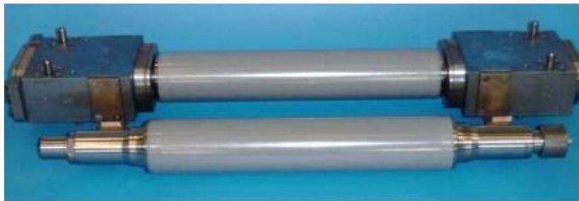
4. ábra. \text{Si}_3\text{N}_4 kerámiából készült hengerek alakító műveletekhez [11]
