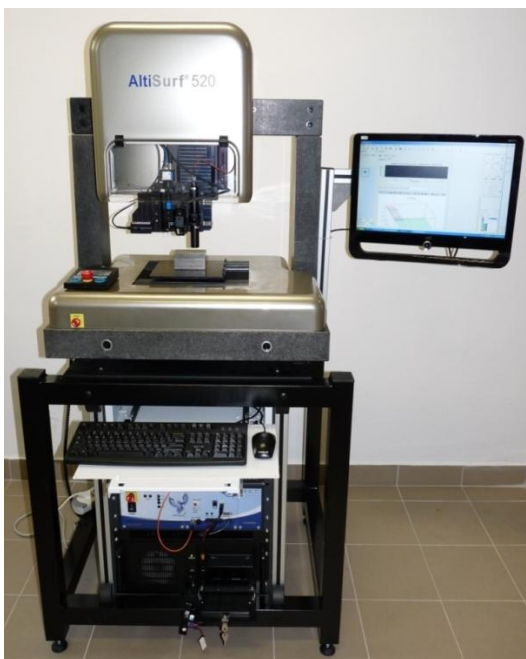
32. ábra. Altisurf 520 háromdimenziós felülettopográfiai berendezés [99]
