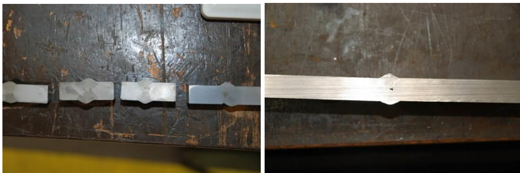
10. ábra: Átolvadási hiba a K kötésben
