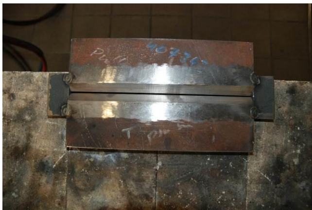
8. ábra: Előkészített hegesztési próba
