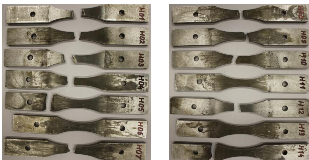
17. ábra: Nagyciklusú fárasztó vizsgálat próbatestei, vizsgálat után (hegesztett kötés)
