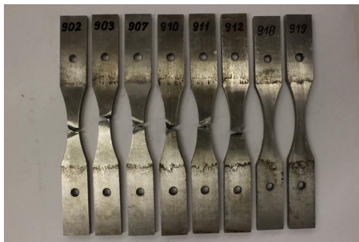
16. ábra: Nagyciklusú fárasztó vizsgálat próbatestei, vizsgálat után (alapanyag)
