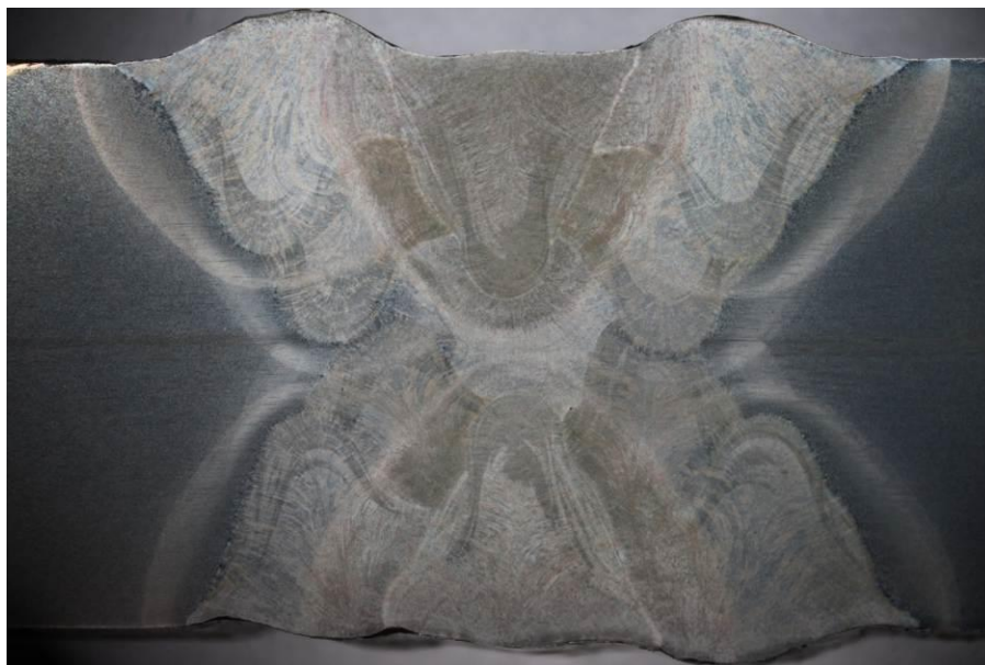
11. ábra: Makrocsiszolati kép (2% HNO 3 )
