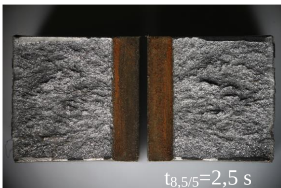
18. ábra Az alapanyag szívós töretfelülete
