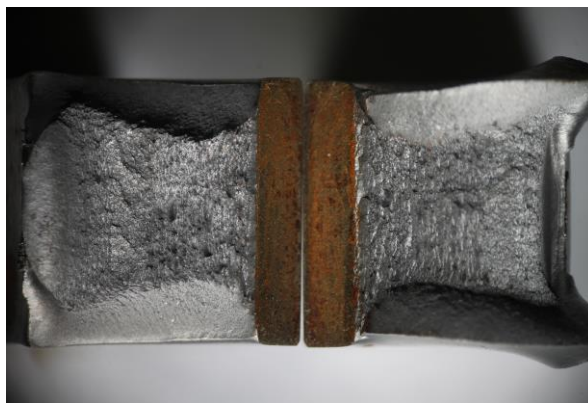
18. ábra Az alapanyag szívós töretfelülete
