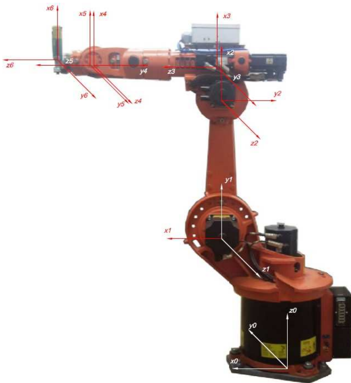
2. ábra: KUKA robot a csuklóban elhelyezett koordinátarendszerekkel
