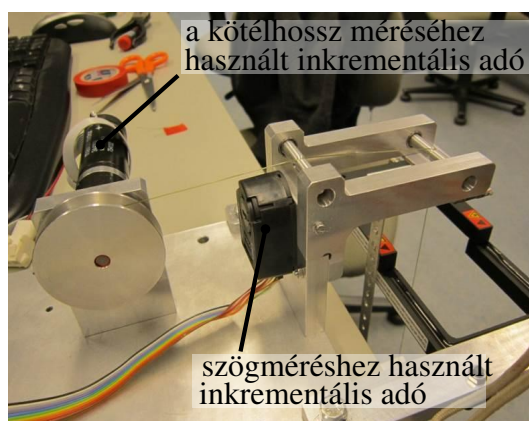
9. ábra. A bakdarun x_r és x_\theta mérésre alkalmazott inkrementális adók.
