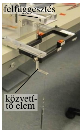
10. ábra. A bakdarun alkalmazott inkrementális adóra épülő szögmérő szenzor.
