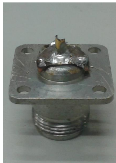
4-12. ábra, A mérési elrendezés, és a rövidre zárt N-csatlakozó
