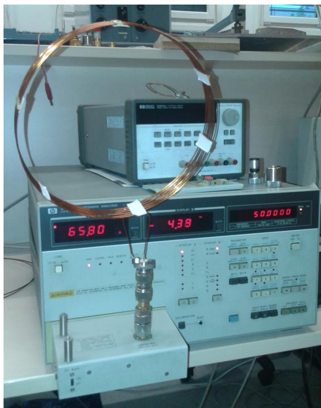
4-12. ábra, A mérési elrendezés, és a rövidre zárt N-csatlakozó
