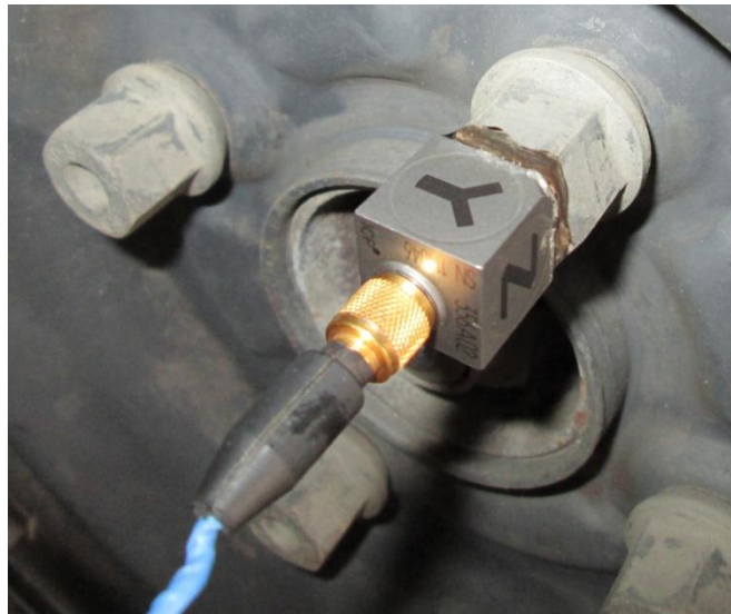
3.4. ábra: A piezoelektromos szenzor helyzete a gumiabroncs rezgésmérésénél
