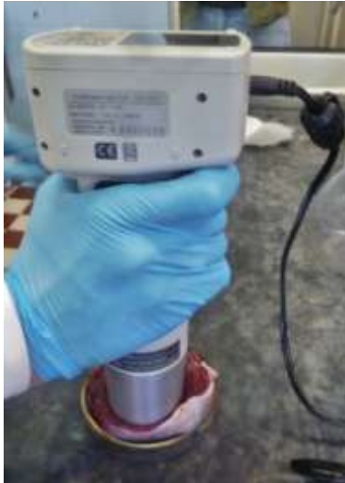
4. kép: Szarvashús minta szín-értékek mérése Konica MINOLTA chromameterrel (Bleier, 2013)
