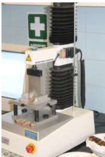
11. kép: Warner-Bartler pengével ellátott TA.XT Plus texture analyser próbatest vágása közben I. (Bleier, 2013)
