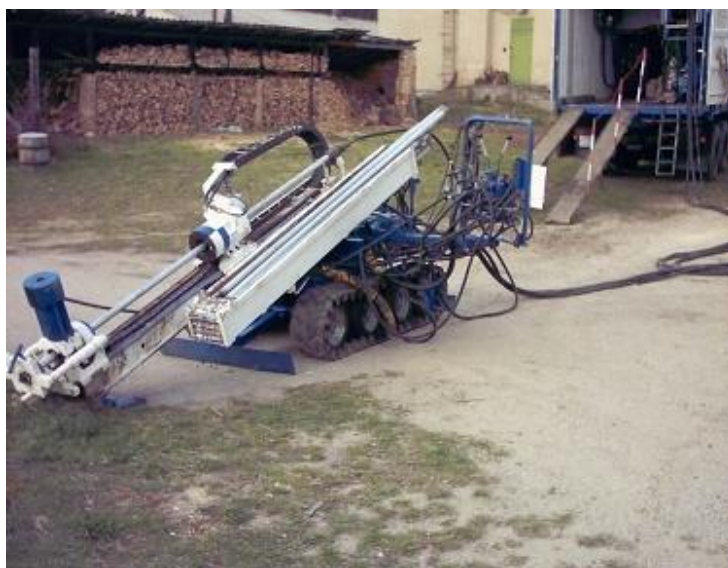
35. ábra. Felszínbontás nélküli vezetékekfeltetésre használt fúrógép, forrás: http://www.geoclean-terrorbor.hu/images/terrorbor3k1.jpg , letöltés ideje: 2014.10.28 15:18
