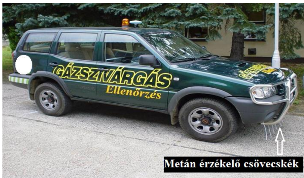
15. ábra: Gázszivárgás ellenőrző gépjármű, Forrás: E.ON Tűzementani modul ppt.
