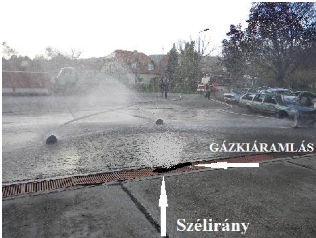
23. ábra: "U" alakú vízfüggöny, Forrás: a szerző
