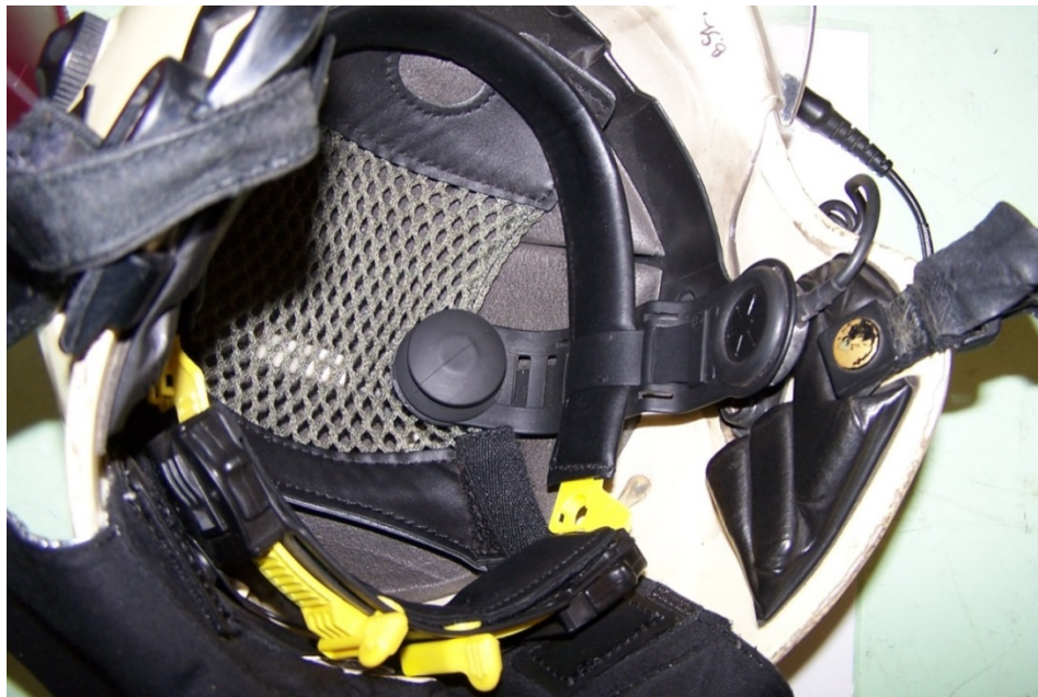
16. sz. ábra: A tűzoltó sisakhoz rendszeresített koponyamikrofon (a felvételt készítette a szerző)
