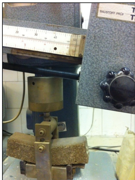
6. kép. Húzó-hajlító szilárdsági vizsgálat
