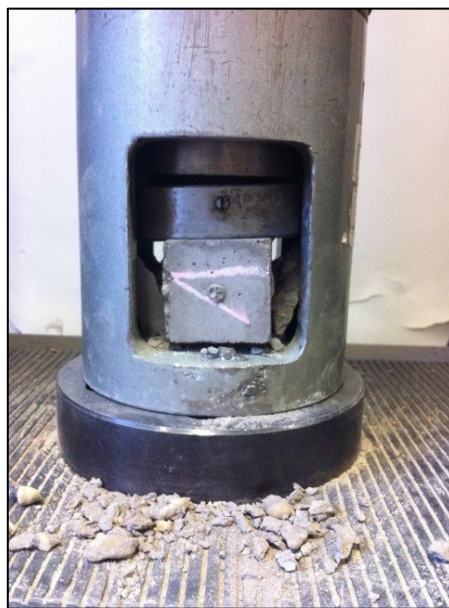
7. kép. Nyomószilárdsági vizsgálat
