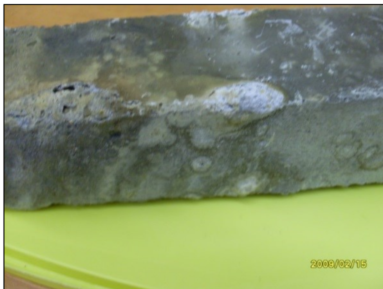
9. kép. Metánreaktorban tárolt hasáb
