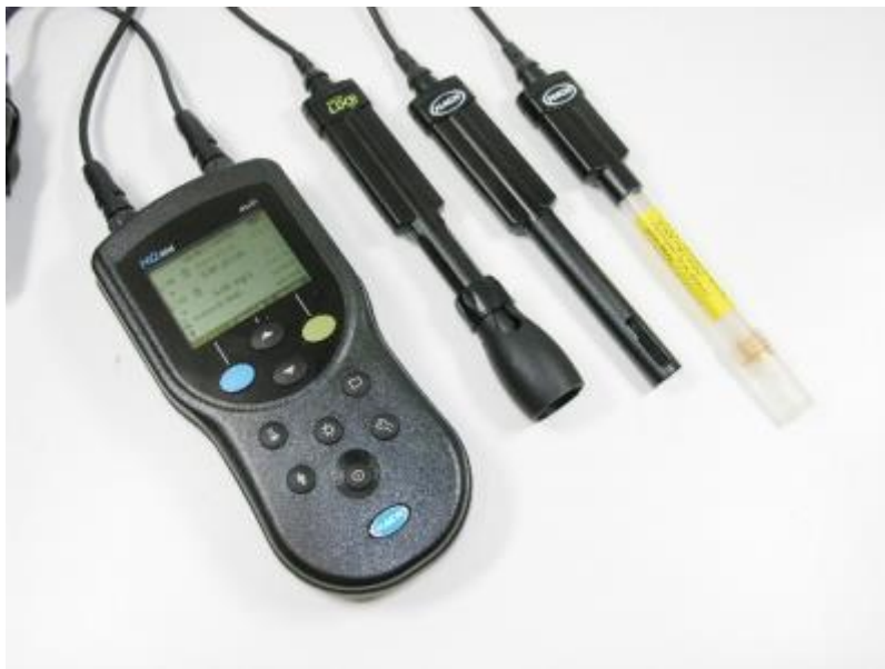
8. ábra Multiparaméteres kézi műszer (Hegyi, 2014)
