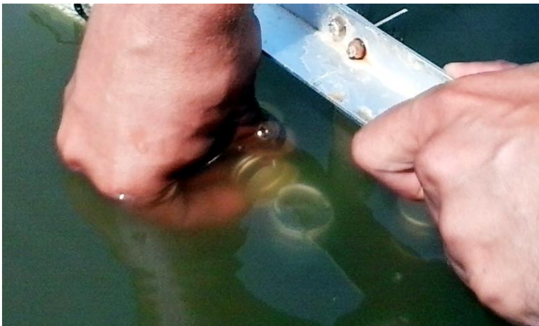
III. ábra: A kupak víz alatti rátétele a palackra
