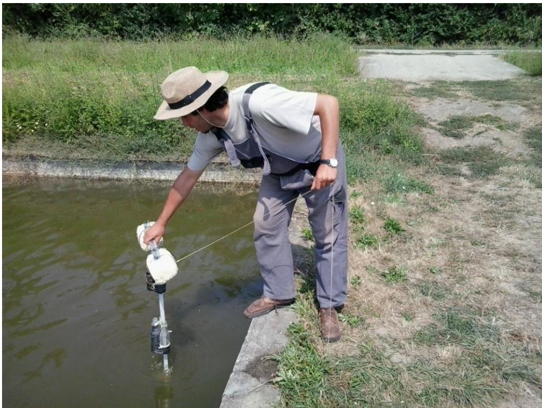
II. ábra: Úszóállvány belehelyezése a tóba
