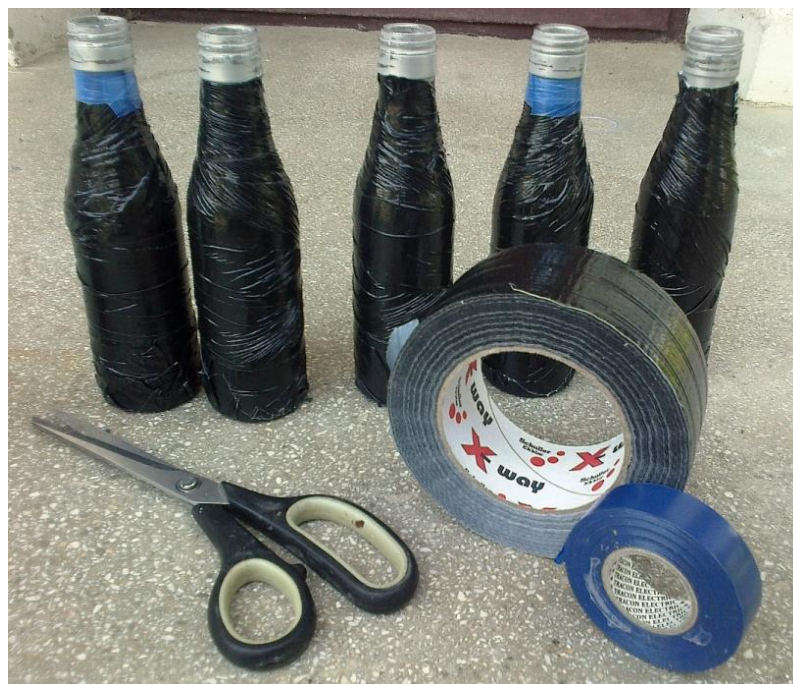
18. ábra: A palackok sötétítése szigetelő szalaggal
