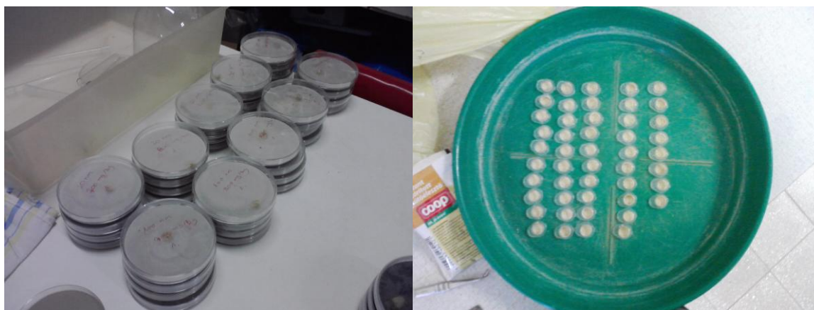
11-12. kép: Az OECD módosított változatához használt Petri-csészék és az Eppendorf kupakokba helyezett élesztők (Kiss 2014)
