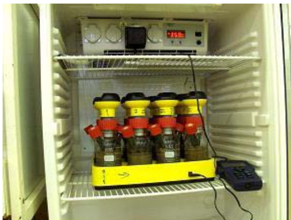
4. ábra: A biogáztermelődés meghatározására szolgáló OxiTop mérőrendszer
