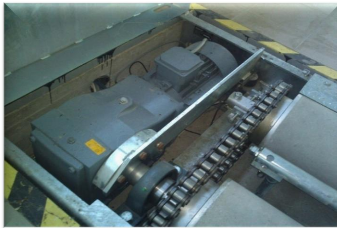
21. ábra ENERGETEST Uni 12/30 görgőpados fékmérő pad meghajtó és erőmérőcellás egysége. (Forrás: ENERGETEST Kft)
