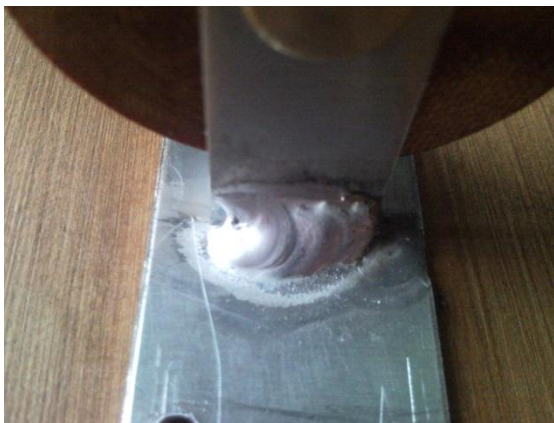
28. ábra Tartó elemek hegesztett kötése
