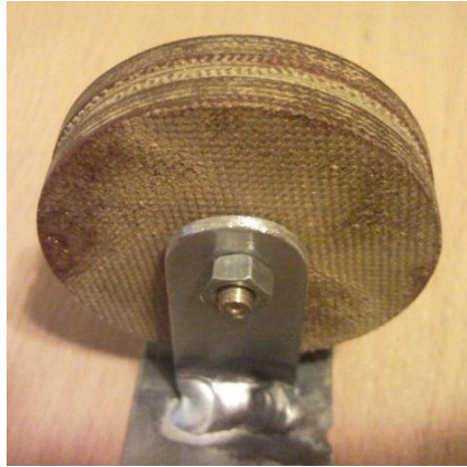
25. ábra A textil-bakelit csiga
