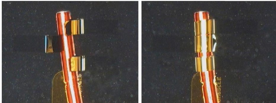
2. ábra 0,5mm vastag vezetéket megfogó mikroaktuátor
