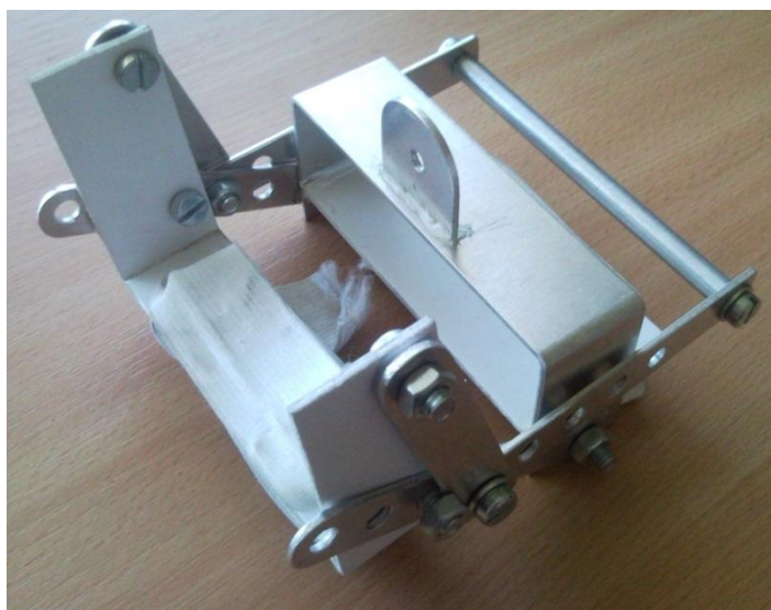
27. ábra Az ujjakat tartó rész összeállított állapotban
