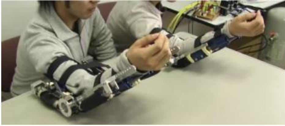
12. ábra Elöl a „Master”, hátrébb a „Slave”
