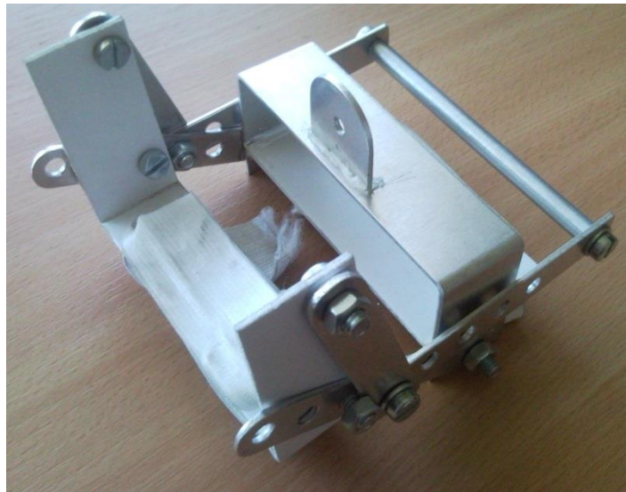
27. ábra Az ujjakat tartó rész összeállított állapotban
