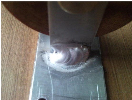
28. ábra Tartó elemek hegesztett kötése
