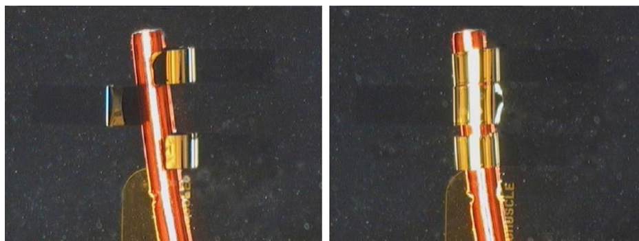
2. ábra 0,5mm vastag vezetékét megfogó mikroaktuátor
