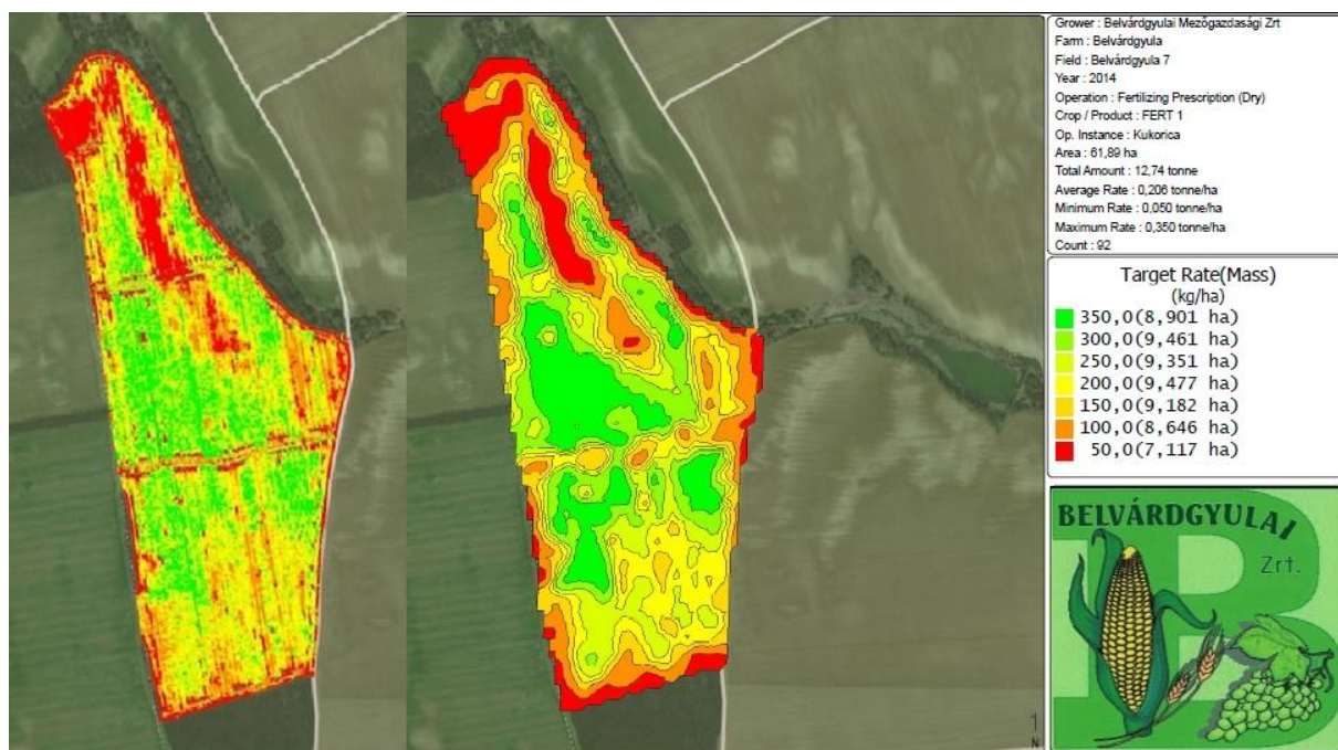
20. ábra: Hozamtérkép és az abból készített tápanyag kijuttatási térkép
