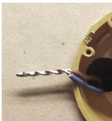
29. ábra Forrasztott kötés 1,5 mm 2 réz vezetékekkel
