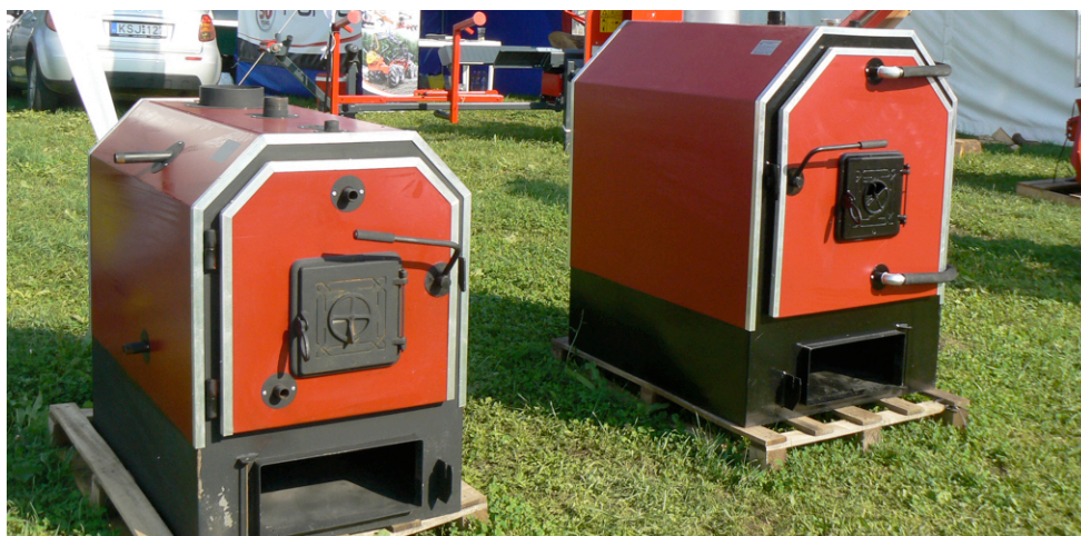
1. kép: Nagytűzterű kazánok
