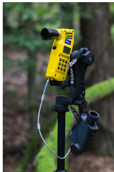
9.4. ábra: TruPulse lézeres távolságmérő és Criterion RD 1000 lézeres relaszóp
