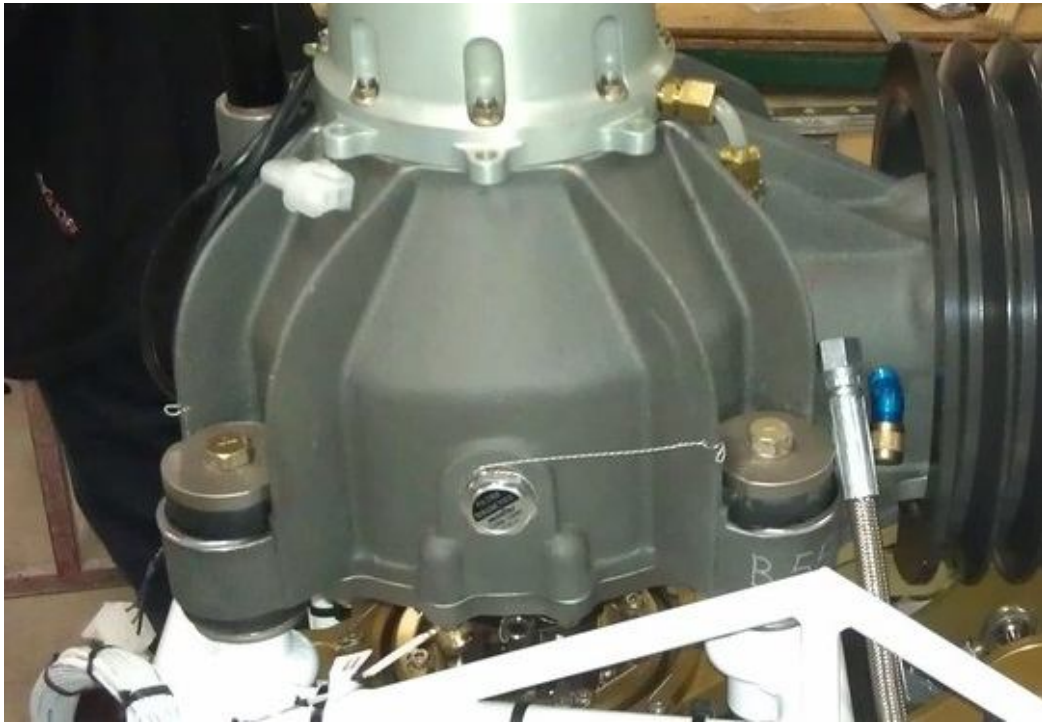
19. ábra A CH-7-es helikopter hajtóműháza, és rögzítési módja.
