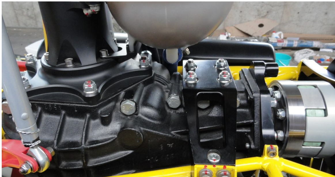
17. ábra A HC-01-es helikopter hajtóműve
