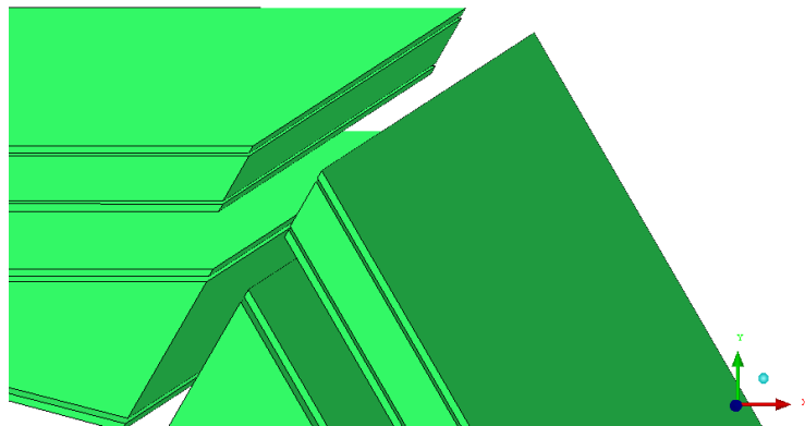
4-9. ábra: O-grid határréteg blokk izometrikus nézete
