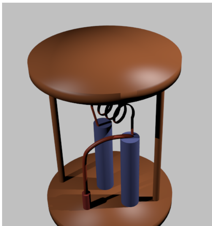
4.3. ábra. A két kondenzátort és a tekercset a korongok közé tettem
