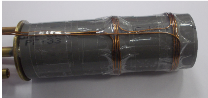
4.10. ábra. Saját készítésű Maxwell-pár, N=4
