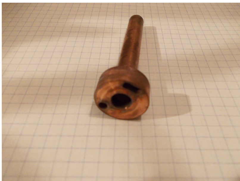
3.8. ábra. Mintatartó tégely vörösrézről. Méreteit lásd a függelékben.
