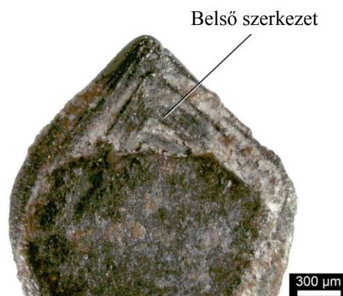
32. ábra: A részlegesen oldott ganoin alatt látható a pikkely belső szerkezete
