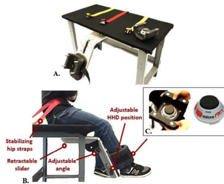
4. ábra: A kézi dynamométer használata a quadricepsz izometrikus erejének meghatározására
