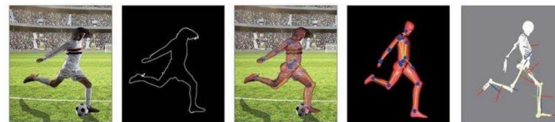
8. ábra: A Simi marker nélküli mozgáskövető rendszerének működése
