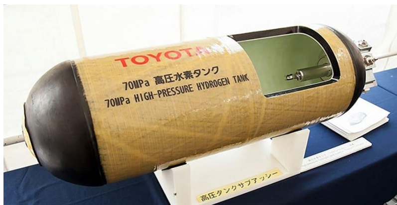
7. ábra Szénszálas kompozit hidrogéntartály a Toyota Mirai gépjárművekhez forrás: Brindusescu, G. (2018). Toyota FCV Hydrogen Tanks are Bulletproof, Autoevolution.
