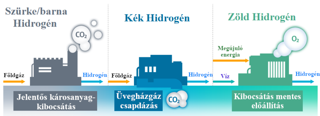
2. ábra Hidrogén előállítása különböző forrásokból saját szerkesztés
